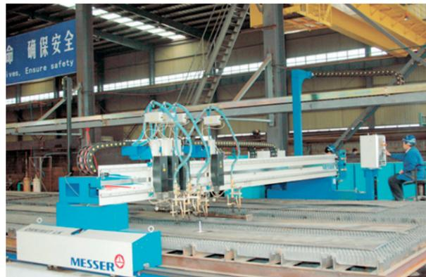
钢板处理线：校平、抛丸、喷底漆、数控下料
